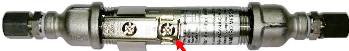
Erdungsanschluß für Potentialausgleich mit mindestens 4 mm<sup>2</sup> bei Verwendung mit brennbaren Medien.
