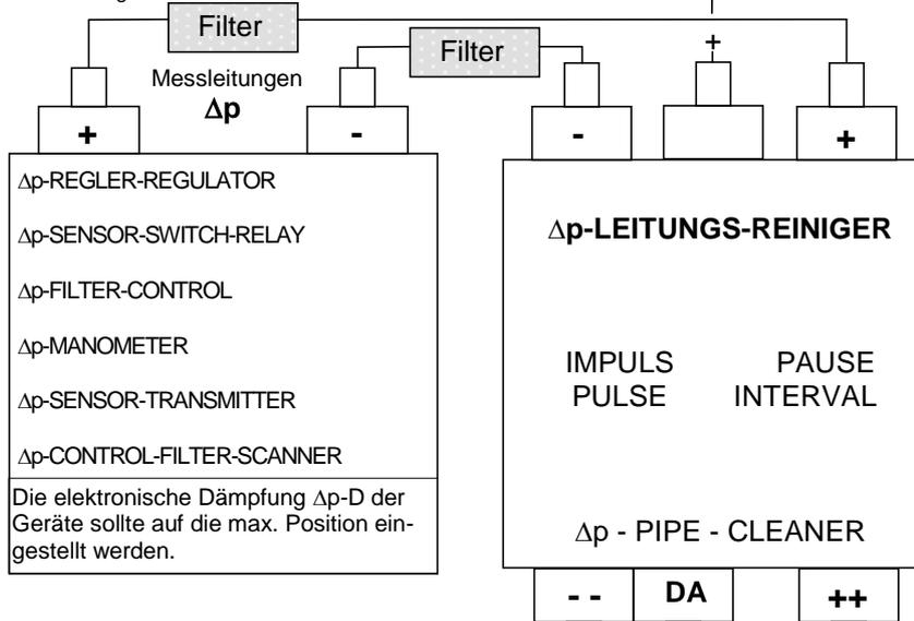
**Druckluft:** ölfrei, trocken, gefiltert, Feinfilter für Partikelgröße ≤ 0,1mm direkt vor dem Drucklufteingang verwenden. **jumes-Filter, min. 4 bar, max. 6 bar**
