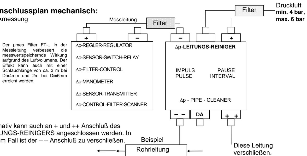
Alternativ kann auch an + und ++ Anschluß des LEITUNGS-REINIGERS angeschlossen werden. In diesem Fall ist der -- Anschluß zu verschließen.
