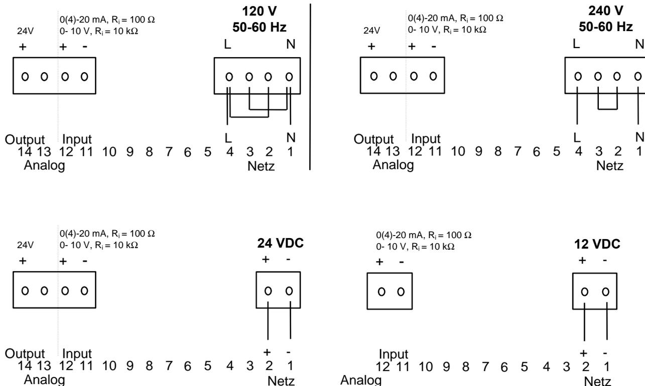
**Transmitteranschluß:**  $\Delta p$  Differenzdruck  $\mu\text{mes}$  Typen: **DMQ\*** und **DPQ\***:
